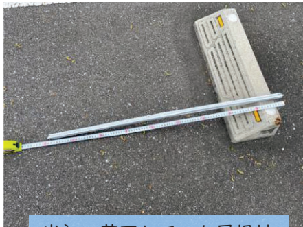
当初、落下していた屋根材 約1.0m、アルミ製
